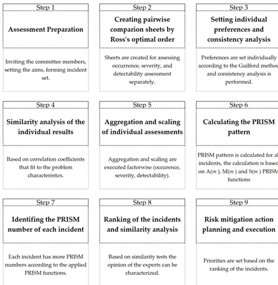
3. ábra: A páros összehasonlításon alapuló PRIZMA módszer lépései
